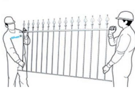
FARE ATTENZIONE: LE SALDATURE SI TENGONO ALL'INTERNO
