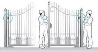
In caso di **Solo anta scorrevole** installare il pilastro interno, al fine di garantire la massima sicurezza.
