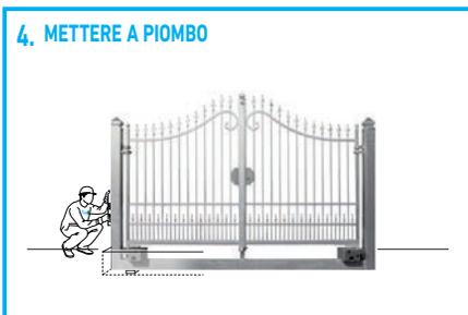
Dopo aver posato il Monoblocco e aver predisposto i tubi per l'allacciamento alla rete elettrica, controllare che non ci siano residui all'interno della cassa di fondazione che possano pregiudicare il funzionamento del motore.
