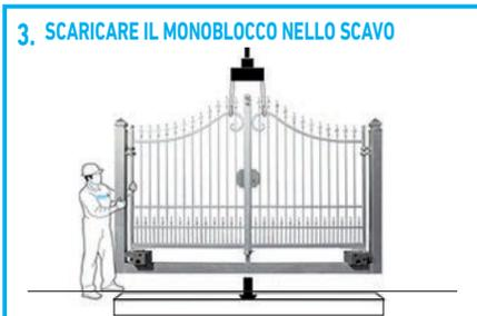
Posizionare almeno 3 spessori per distribuire uniformemente il carico complessivo della struttura in Monoblocco.
